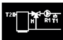
Schéma s 3-cestným ventilem na zpátečce
