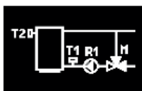
Schéma s 3-cestným ventilem od zdroje vytápění
